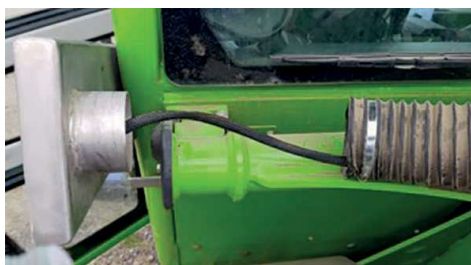
Exemples d'emplacement de percement pour la mesure du débit d'air
