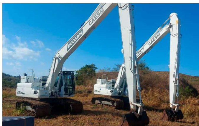
Pelles long bras avec cabine pressurisée
